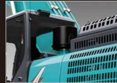
新型空气预滤器 带有灰尘自动排出功能，节省日常维护时间。
