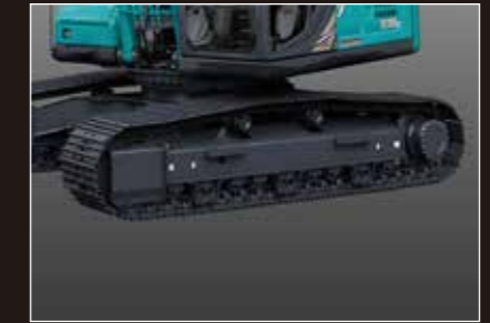
增强型履带校正框(单侧3个) 防止在恶劣的矿山现场的链轨脱落。
